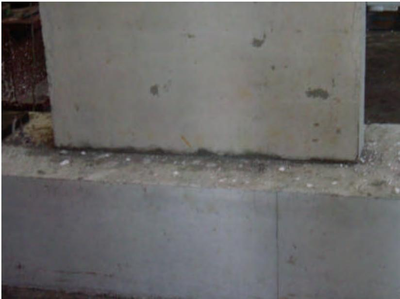
**2. Comportamiento de la junta horizontal de unión de dos piezas de forjado, cuando se carga una pieza con la carga de rotura de la suma de las dos.**
